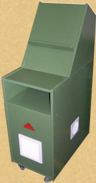
Let flytbar kasse på hjul til motor og pumpe. Ventilator til afkøling af motoren er monteret indvendig.
