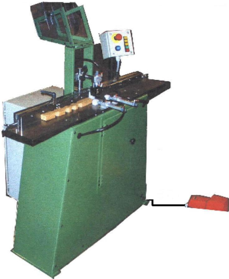
Die perfekte Maschine zum Präzisionsfräsen vom Kamm in Sprossenleisten. Die Sprossenfräsmaschine KS ist auch für "befestigte Sprossen" verwendbar.
