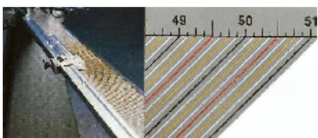
Die präzise eingravierter Maßskala ist auf den DeLuxe Maschinen standard. Die Striche sind gefärbt, um leichter und besserer Unterscheiden und Einstellung der Länge zu erreichen.
